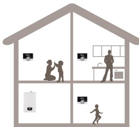
Baxi Mago wireless: per le pompe di calore, con un unico gateway è possibile gestire più zone in base alle esigenze di comfort degli ambienti domestici. È necessario acquistare tanti cronotermostati quante sono le zone che si intende gestire, oltre la prima (fino ad un massimo di 3 zone). Qui di seguito un esempio di gestione di 3 zone.
