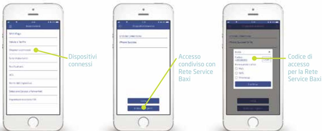
Baxi Mago può essere connesso a più di uno smartphone o tablet: tutti i membri della famiglia possono accedere a Baxi Mago e controllare a distanza il riscaldamento. È inoltre possibile condividere un accesso sicuro e temporaneo (3 giorni) con la Rete Service Baxi, per effettuare una prima diagnostica e accedere a funzionalità avanzate.
