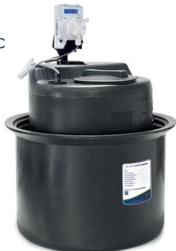
Stazione di dosaggio Simply per impianto idrico che garantisce un dosaggio proporzionale al reale consumo d'acqua (necessita di contatore lancia impulsi installato nel sistema). Pompa multifunzione digitale con corpo pompa in PVDF. Portata pompa: 6 lt/h - prevalenza pompa: 8 bar - alimentazione elettrica: 240Vac-50Hz
