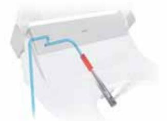
Grazie al dispositivo di sicurezza integrato, SensoWash® Starck e è conforme alla normativa EN 1717 in materia di protezione dall'inquinamento dell'acqua potabile negli impianti idraulici.
