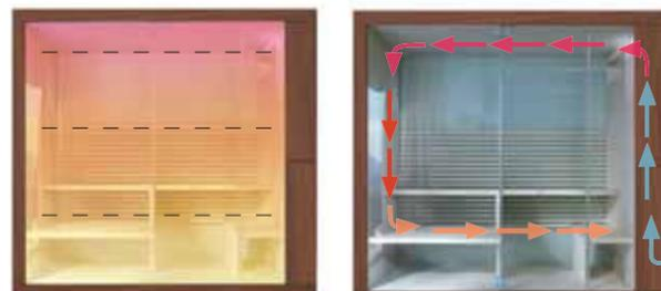
Il riscaldamento migliorato permette di raggiungere i 110°C sotto il soffitto. A livello della panca superiore, la temperatura è di circa 75°C e seduti o stesi su quella inferiore di circa 60°C.
