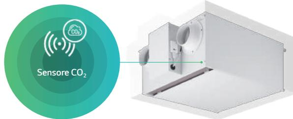
Monitora la concentrazione di CO<sub>2</sub> dall'aria in uscita dalla stanza. Aumenta la ventilazione quando la concentrazione di anidride carbonica è elevata, e riduce automaticamente la ventilazione se è troppo bassa.
