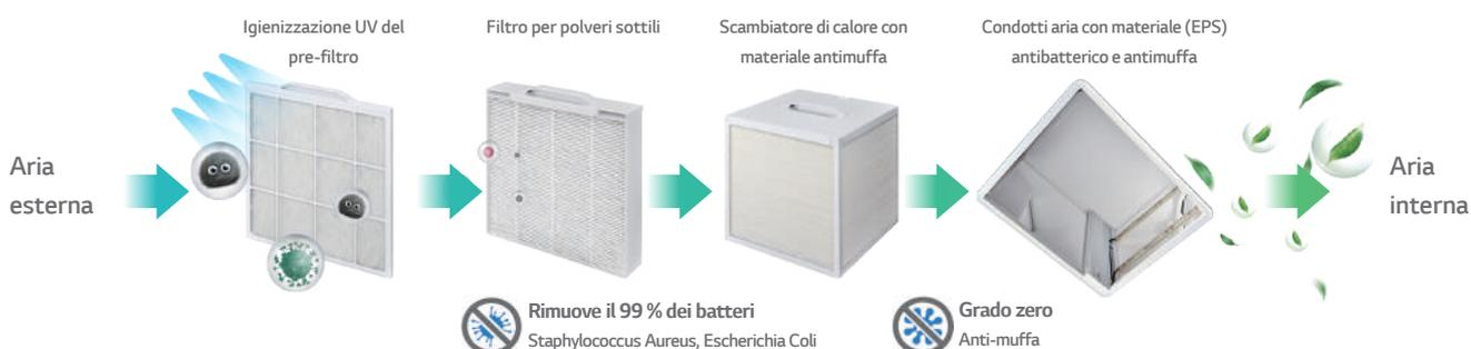
\*Test di resistenza alla muffa dell'elemento di scambio: Periodo del test: 20. 11; Istituto di prova: FITI Testing and Research Institute; Specifica di prova: ASTM G21-15; Ceppi di prova: Aspergillus brasiliensis, Chaetomium globosum, Penicillium funiculosum, Trichoderma virens, Aureobasidium pullulans; Condizioni di coltura: 28-30°C, Umidità relativa 85% o superiore, 28 giorni; Risultato del test: Nessuna crescita (grado 0)
