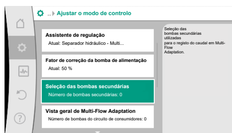
Fig. 57: Assistente de regulação – Seleção das bombas secundárias
