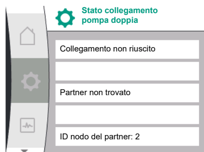
Fig. 52: Collegamento doppio fallito
