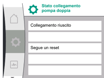
Fig. 51: Collegamento di pompa doppia riuscito
