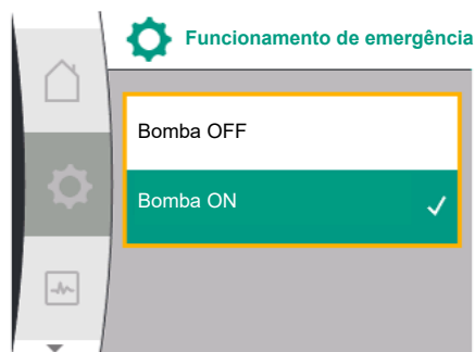
Fig. 43: Regulação do funcionamento de emergência
