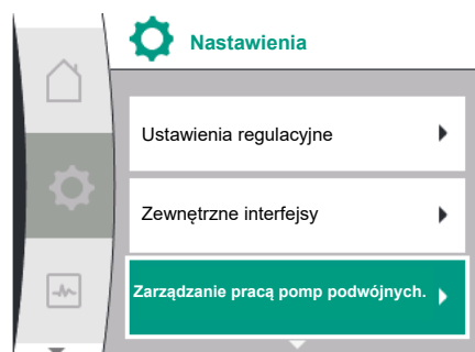
Fig. 48: Menu Zarządzanie pracą pomp podwójnych
