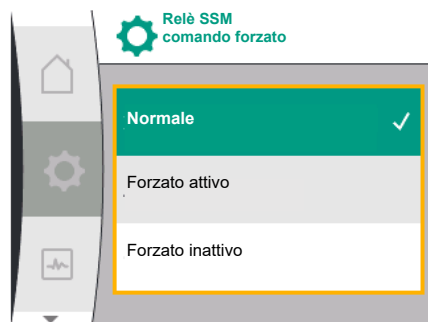
Fig. 62: Comando forzato relè SSM
