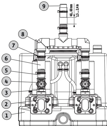
Fig. 3: Montaggio del raccordo di mandata
