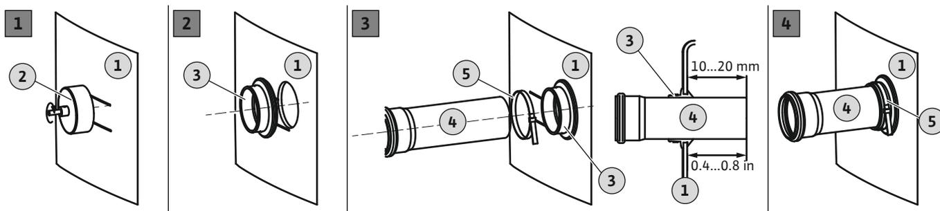
Fig. 5: Collegamento dell'alimentazione
